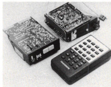
Afb. 7. Het programmeergeheugen van TV-toestellen vereenvoudigt de afstemming van ontvangers op een gewenste zender. De ontwikkeling leidde van mechanische instelling van de oscillatiefrequentie in het jaar 1961 tot het door AEG-Telefunken ontwikkelde digitale programmeergeheugen in 1977. Op deze foto ziet men een digitaal programmeergeheugen met fasevolgafstemmer en afstandsbediening (1977).
